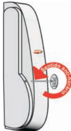
Detalhe do sistema de destravamento.
