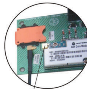
Local para conexão da antena ao módulo celular G24
